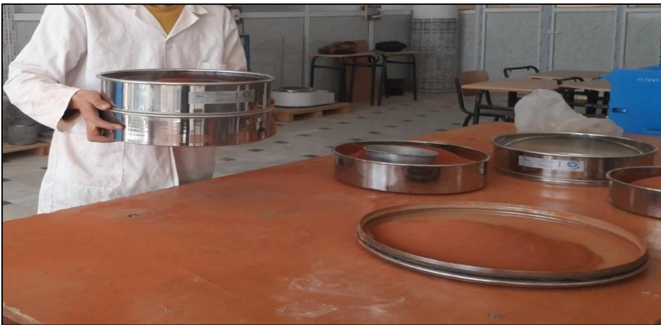
Photo III.11 : Tamisage manuellement de la poudre et granulés des briques.
