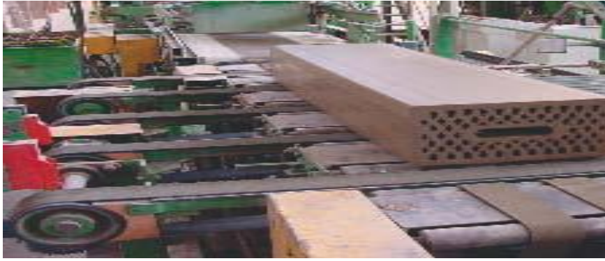
Figure II.17 : Façonnage de la brique [6].
