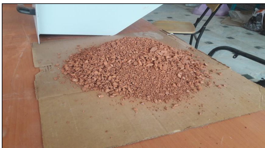
Photo III.6 : Les granules des briques que nous obtenus de la machine concasseur.
