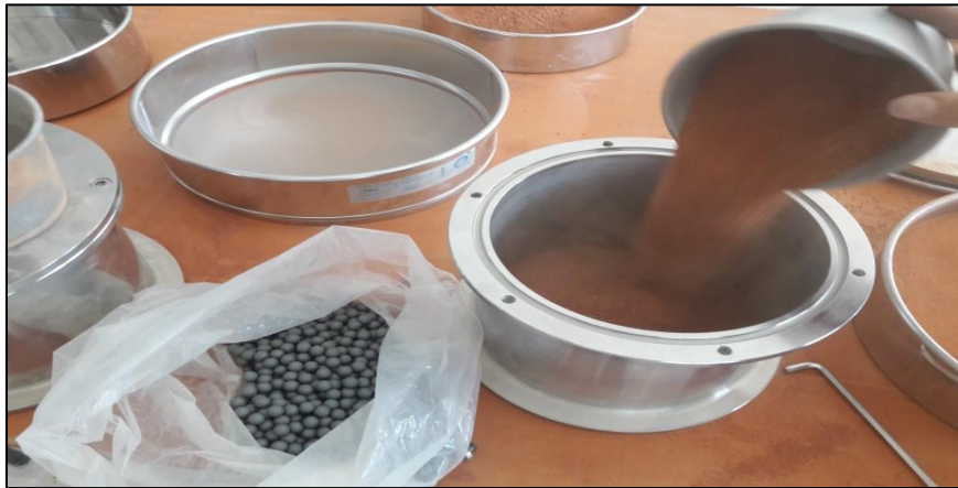
Photo III.8 : Granulés de brique dans le Moule de la machine de Micro Duval avec granulés de fer.
