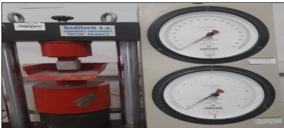
Photo III.23 : Dispositif de l'essai mécanique de Compression.
