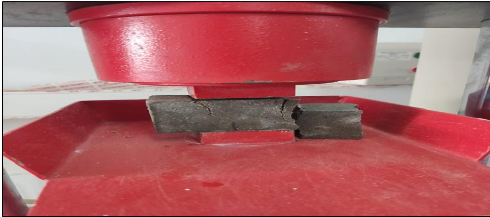
Photo III.22 : Dispositif de l'essai mécanique de Compression.
