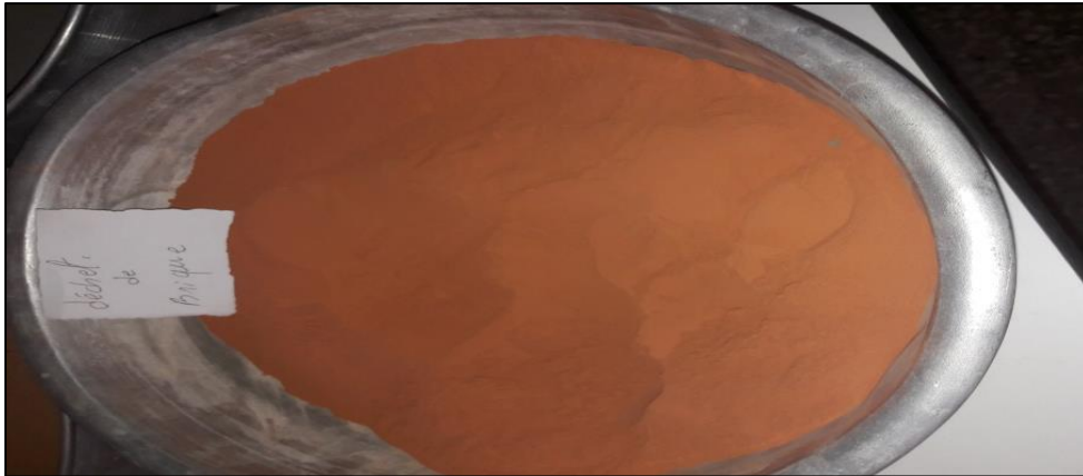
Photo III.13 : La poudre finale de brique qui est passée sur le tamis 0.08 mm.
