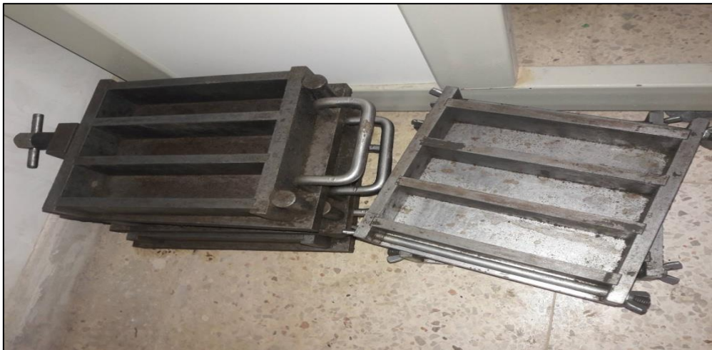
Photo III.14 : Moule normalisé de 40x40x160 mm.
