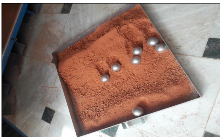
Photo III.7 : Les granules des briques que nous obtenus de la machine los Anglos.
