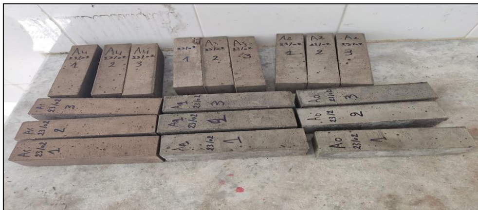
Photo III.20 : Démoulage les échantillons.
