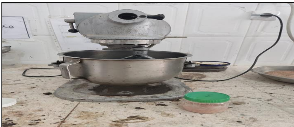
Photo III.16 : Malaxeur électrique utilisée dans la fabrication du mortier [Labo Béton – LTPS].
