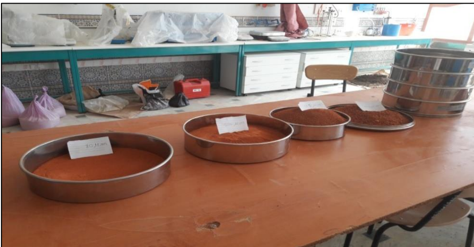
Photo III.12 : Classification de la poudre de brique en fonction du diamètre des granulés.
