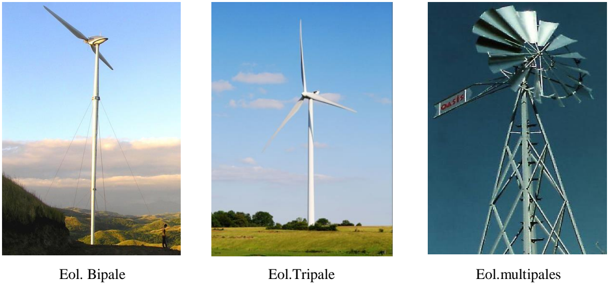
Fig. I-11 Eoliennes à axe horizontale
