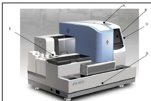
Figure 2. Analyseur d'immunoanalyse automatisé marque AIA-900. A. Imprimante, B. Panneau de commande et clavier, C. Ports de connexion externes, D. Chargeur d'échantillons, E. Position d'installation du substrat, F. Capot de l'unité de lavage, G. Capot des réactifs et des embouts, H. Plateau pour réservoirs et I. Interrupteur de marche/arrêt.
