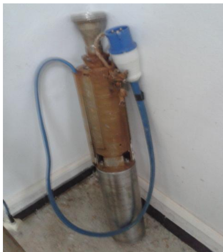
Pompe Grundfos SQF5A-6
