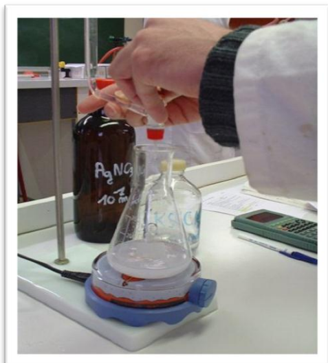
Figure III.14 : titrage de chlorure par \text{AgNO}_3
