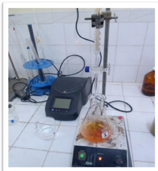
Figure III.11 : titrage de TAC par HCl
