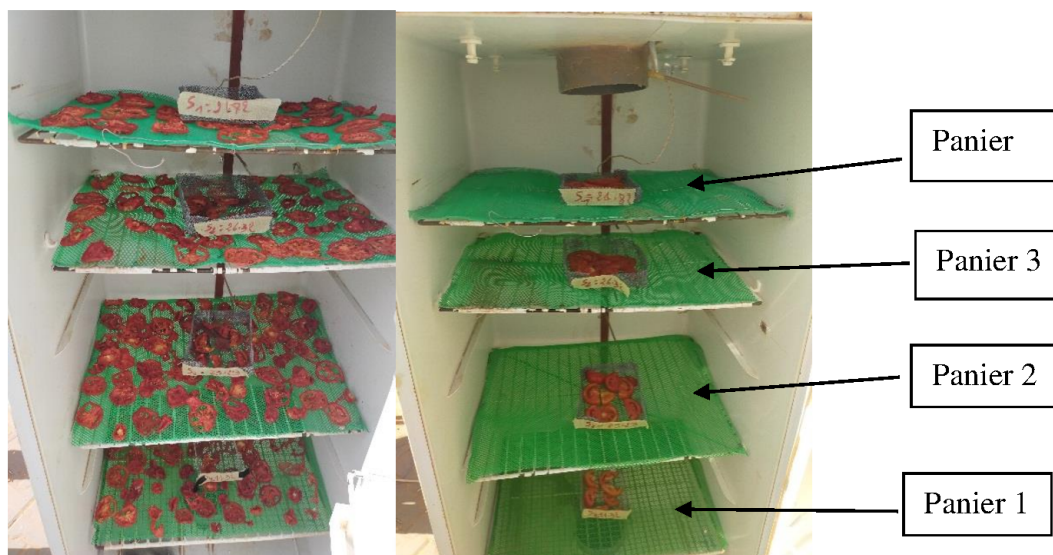
Figure 3.4 Photographie d'une armoire de séchage avec 4 étagères
