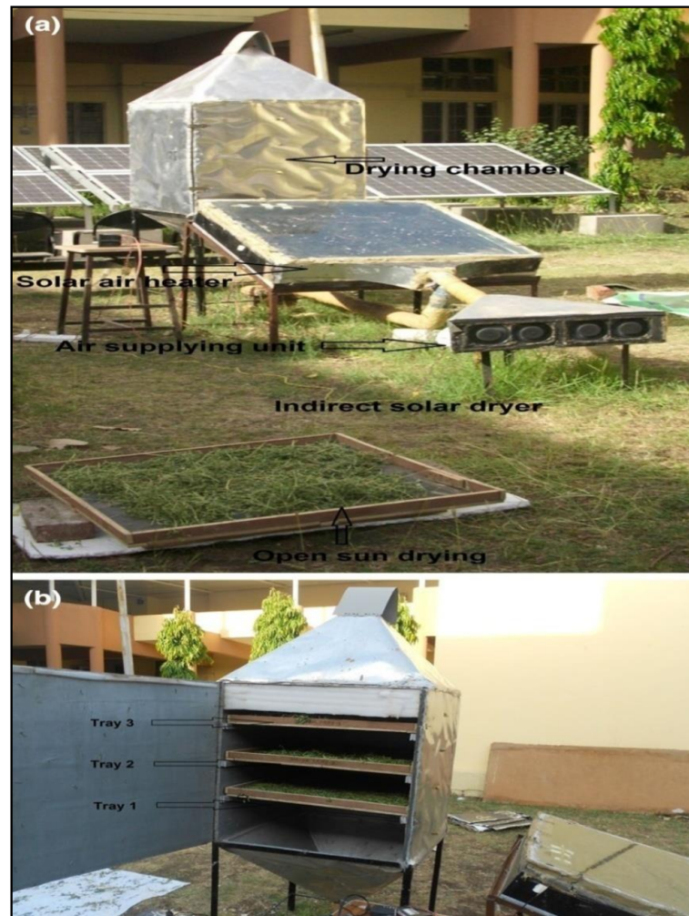
Figure 2.6 Vue photographique du séchage du fenugrec a dans un séchoir solaire indirect à convection forcée et en plein soleil, b vue intérieure du séchoir solaire indirect.
