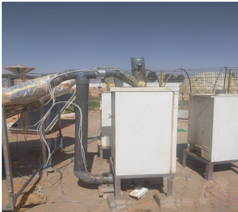
Figure 3.1 Vue générale du séchoir solaire proposé
