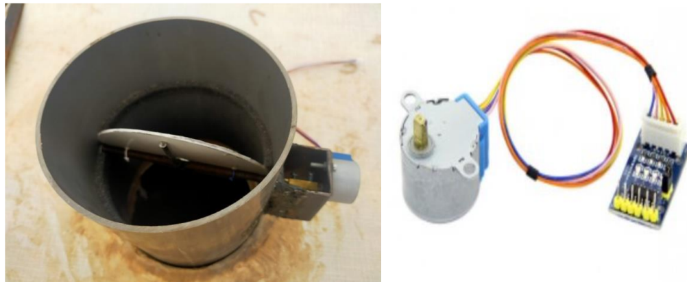
Figure 3.17 a- Vanne motorisée avec un moteur pas à pas b- Moteur pas à pas 28BYJ-48 avec son circuit drive
