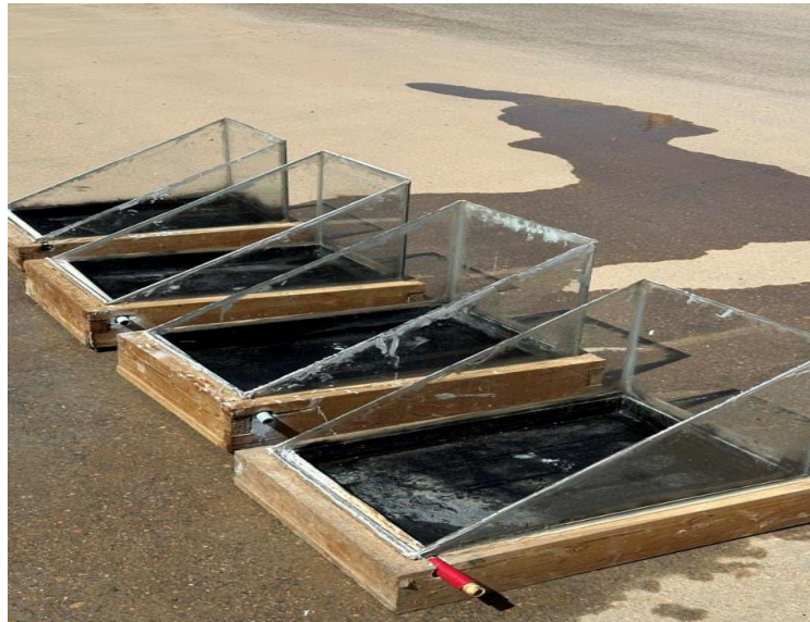
Figure IV. 1. Conception du distillateur Solaire
