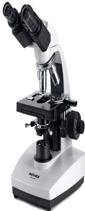
**Photo n°5:** Microscope photonique.
