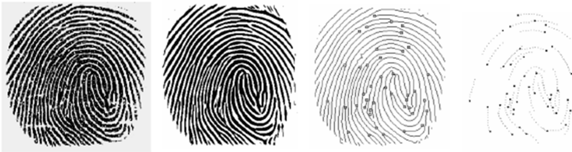
Figure III.27 La binarisation et l'amincissement d'images d'empreintes en utilisant des filtres contextuels [20] Plusieurs approches pour la binarisation, l'amincissement et la détection des minuties ont été proposées dans la littérature [19]
