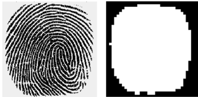
Figure III.26 Un exemple de segmentation d'une image d'empreinte [20]
