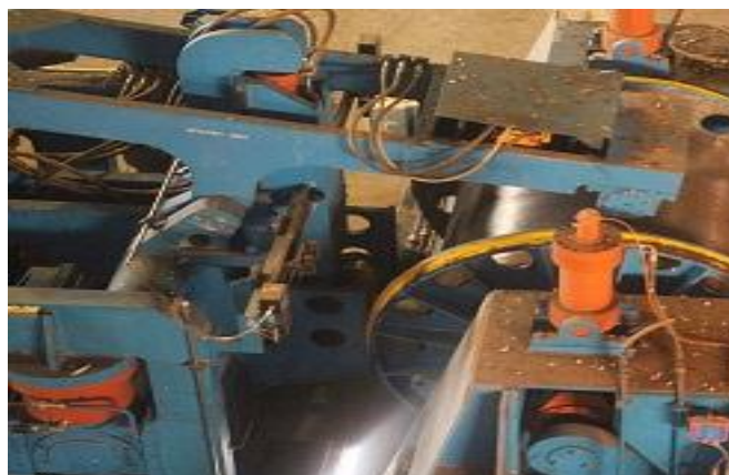
Figure II.4 : Bras de presseur.
