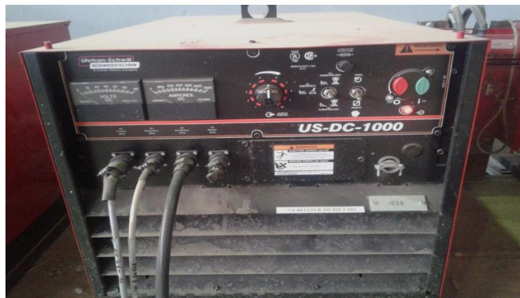
Figure II.15 : Poste de soudage extérieur.
