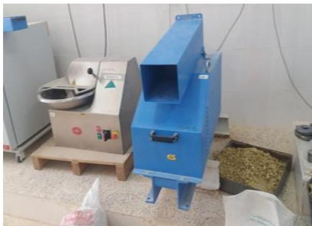
**Photo IV.3** : Utilisation de l'appareil de broyage pour réduire les roches d'argile en particules.
