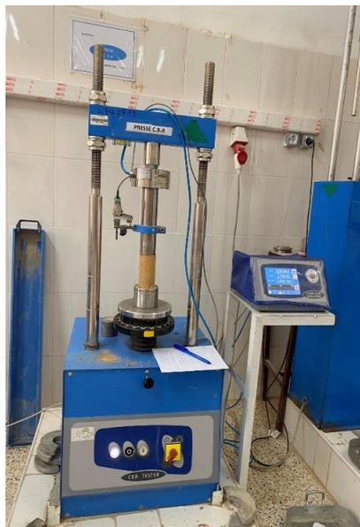
**Photo IV.18:** Éprouvette des échantillons soumise à l'essai de compression.
