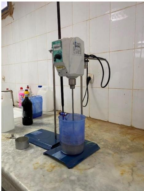
**Photo III.4 :** Essai bleu de méthylène
