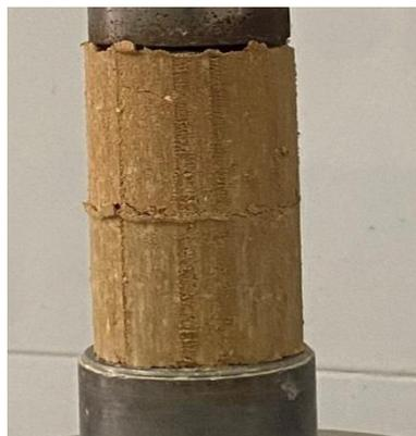
**Photo IV.19:** résistance de compression avec Geo 1 en 01 fibre
