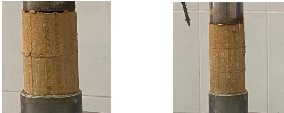
**Photo IV.21:** Résistance de compression avec Geo 2 en 01 fibre et 02 fibres
