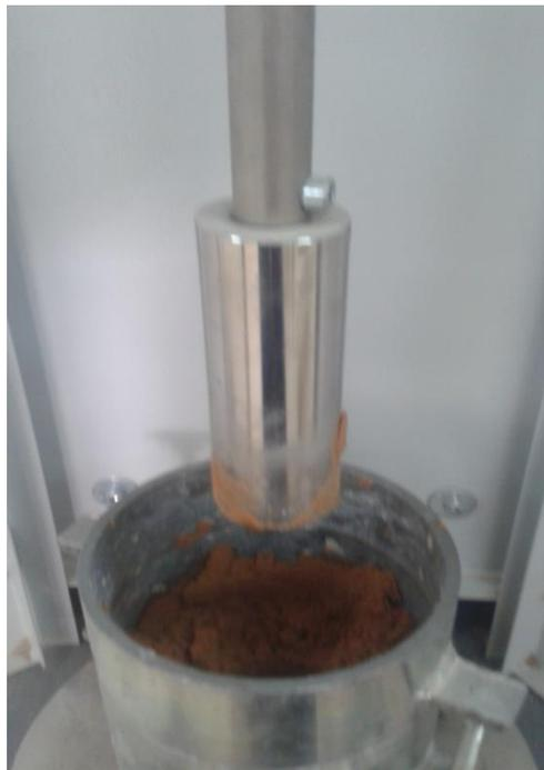
**Photo IV.1 :** Compactage du matériau dans le moule de Proctor modifié
