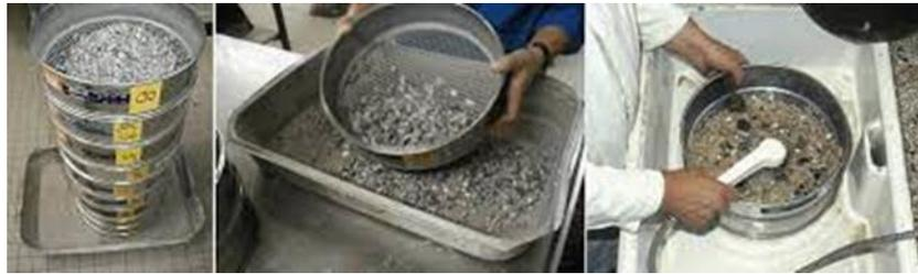
**Figure III.2:** les étapes d'essai Analyse granulométrique par tamisage
