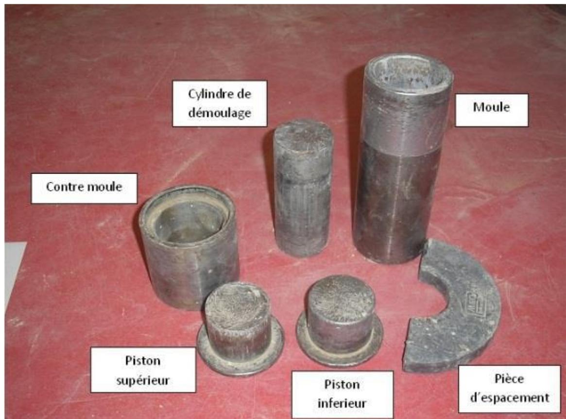
**Photo IV.15:** Eléments pour la confection d'éprouvette cylindrique
