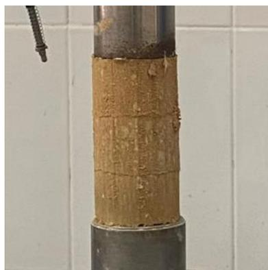
**Photo IV.20:** résistance de compression avec Geo 1 en 02 fibres
