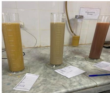
**Photo III.6 : Essai d'équivalent de sable**
