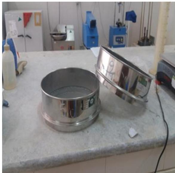
**Photo IV.5 :** Tamisage des particules avec un tamis d'ouverture de 2 mm..
