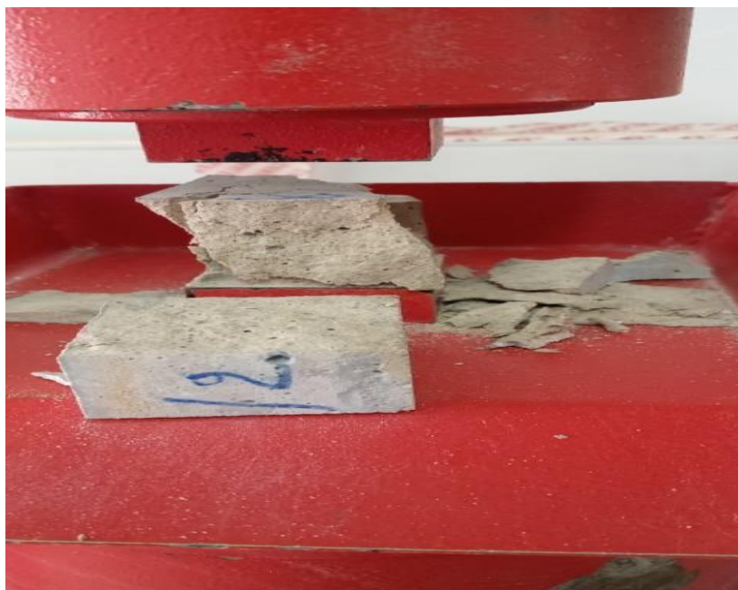
Figure. II- 3 Dispositif de l'essai mécanique de Compression (ZENGOUT, 2023)
