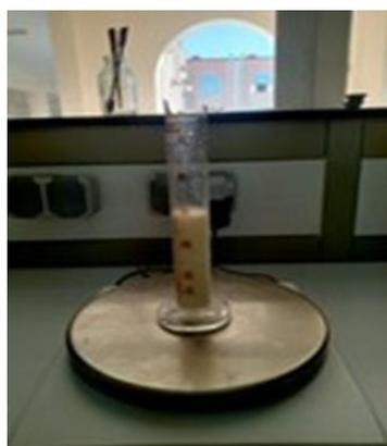
**Figure 04 : Détermination de la masse volumique.**
