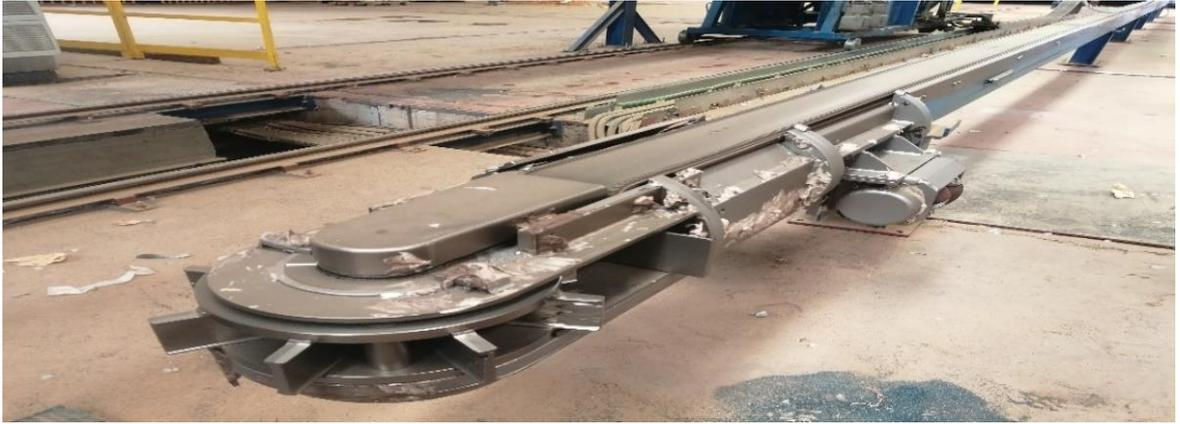
**Fig. I. 9.** La lance et Turbine de grenailage
