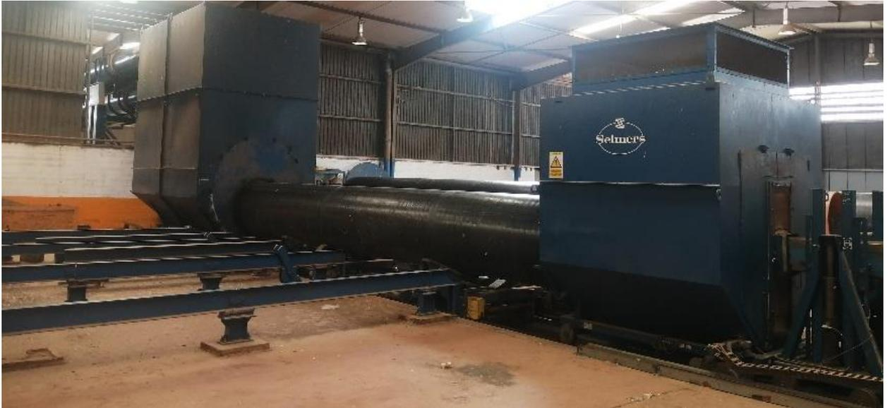
**Fig. I. 6.** L'application de grenailage intérieur
