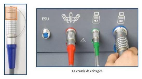
Figure 4.12 La méthode correct de brancher les câbles.
