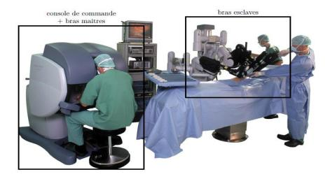
Figure 4.13 Robot Da Vinci lors de la phase de vie (en opération)
