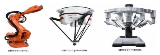
Figure 1.2 Robots manipulateurs
