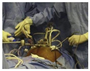
Figure 2.2 Robot porte-endoscope stérilisable en autoclave
