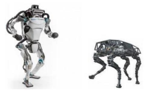
**Figure 1.7** Robots mobiles marcheurs
