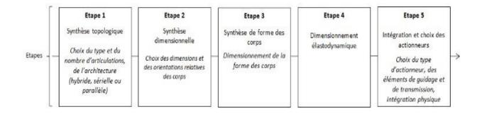
Figure 3.17 Processus de conception d'un robot
