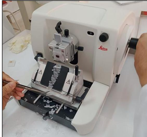
Figure 20:Réalisation des coupes par microtome « Leica ».
