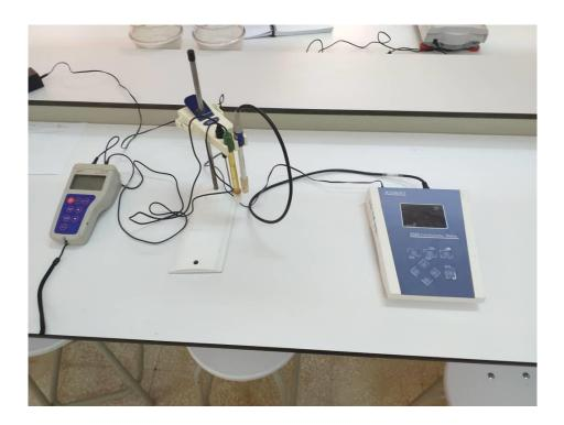
Figure 13 : pH-mètre et Conductimètre
