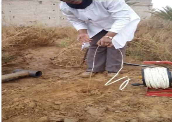
**Photo7.** Sondage du niveau piézométrique de la nappe phréatique
