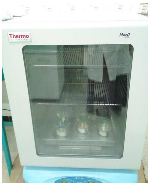
**Figure 5. Shaker rotateur (Original).**
