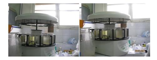
Figure n°17 : Appareil de déshydratation des échantillons.
