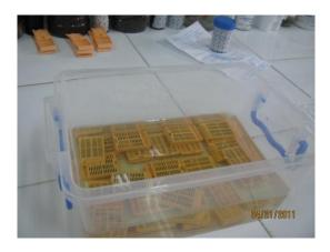
**Figure n°15 :** Fixation des échantillons dans du FAA.
