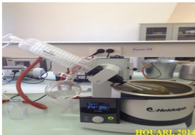
Figure 12 : Montage de Rotorvapor
