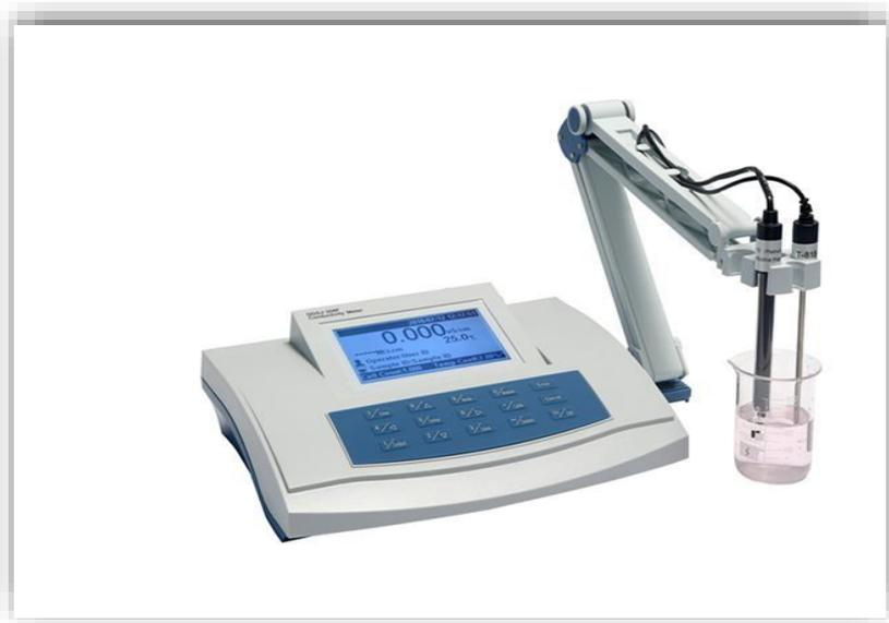
**Figure 09** : Conductimètre
