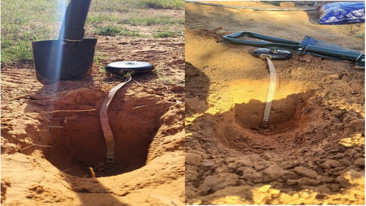
**Figure07 : Prélèvement** de sol avec une profondeur 0\_30 cm.
