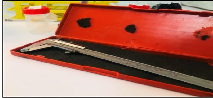
**Figure 14:** Pied de coulisse utiliser pour mesurer la zone d'inhibition (Originale, 2023).
