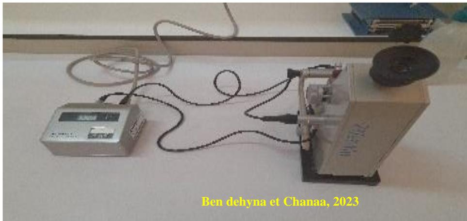
**Figure 7 :** Mesure de Degré de Brix par un réfractomètre (Photo originale,2023).
