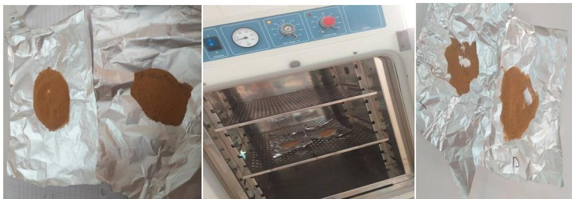
Figure08 :Prétraitement des échantillons de sol.
