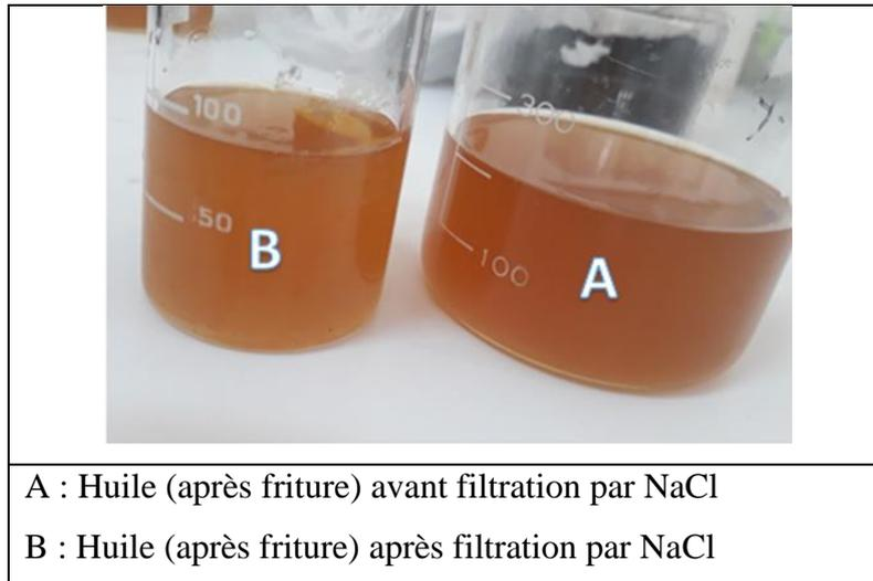
Figure 22: Résultats du traitement chimique d'huiles alimentaires usagées par la méthode (NaCl et H<sub>2</sub>O<sub>2</sub>) (Photos originales, 2023)
