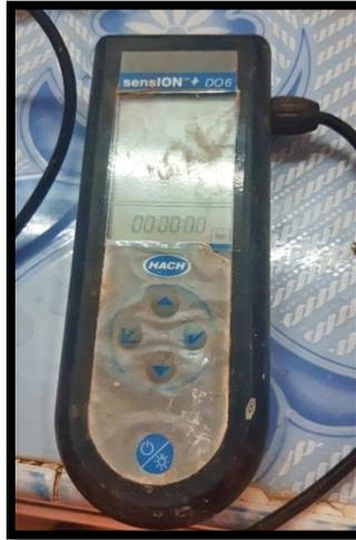
**Figure 15 :** L'oxymètre
