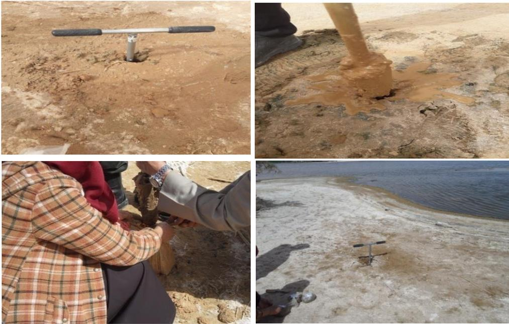
**Figure 27:** Mode de prélèvement des échantillons à l'aide de tarière manuelle (LANOUAR, 2022).
