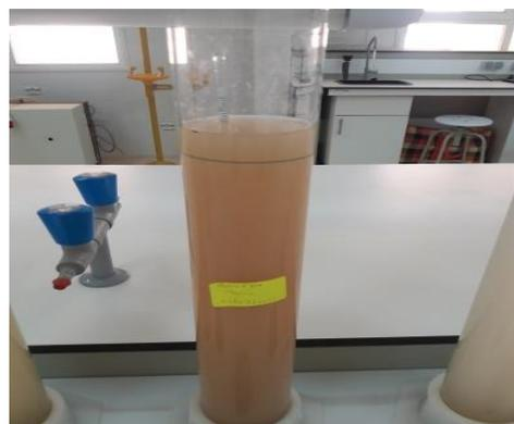
**Figure 24:** Mesure de la densité de liquide par le densimètre de Bouyoucos
