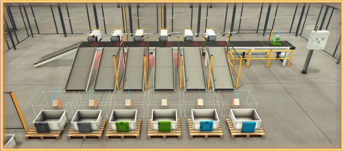
Figure III.35 : unité de tri plaques couleurs et plaques couleurs avec dessin
