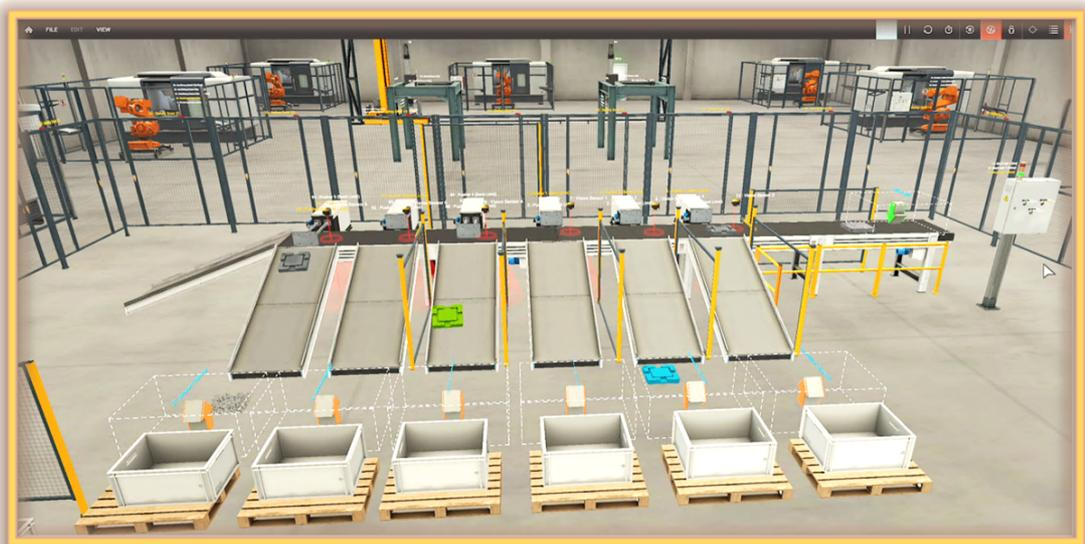
Figure III.38: unite tri par plaques couleurs et plaques couleurs avec dessin
