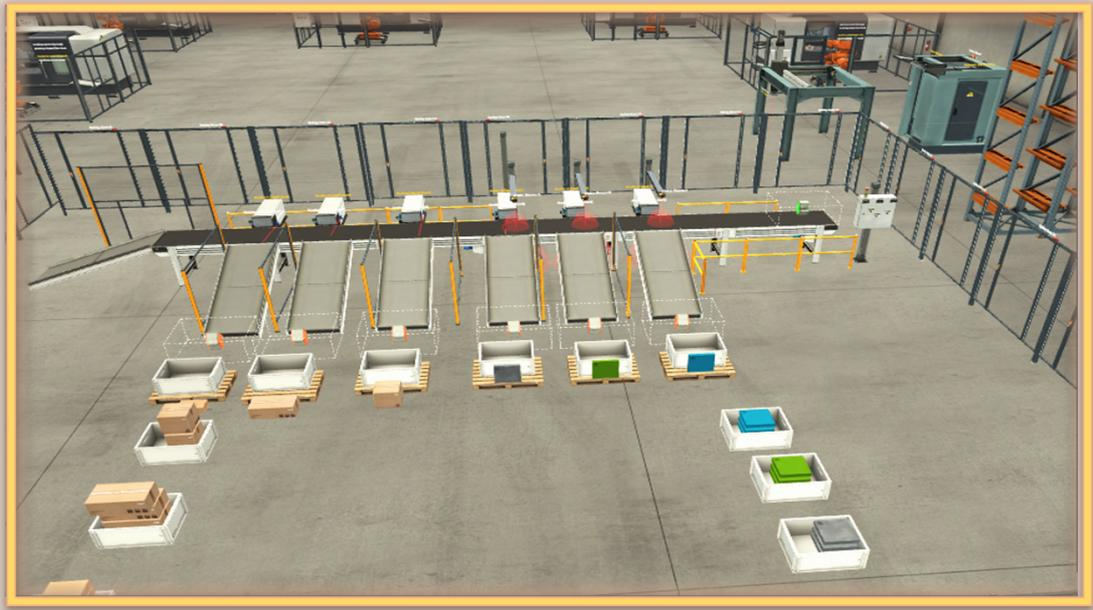
Figure III.27 : unité de tri boîte par taille et plaque par couleur
