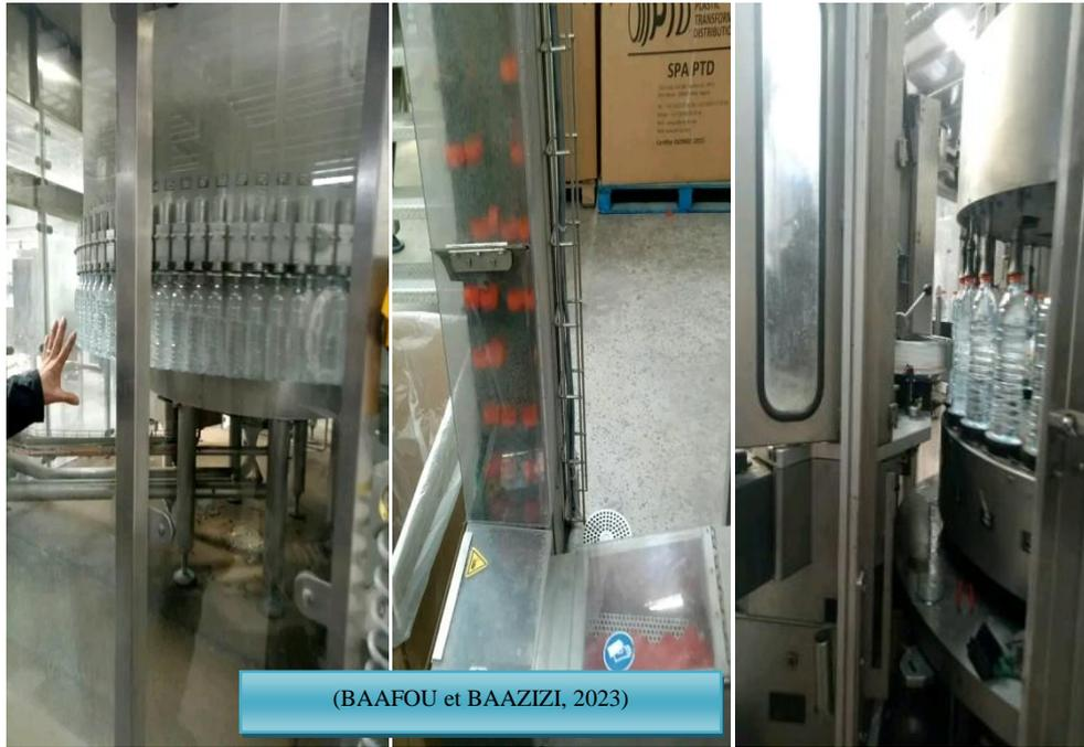
**Photo08.** Remplissage et bouchonnage
