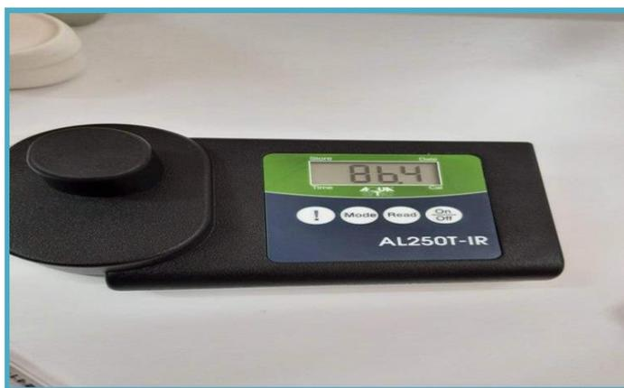
**Figure 09 :** Turbidimètre de type AL250T-IR
