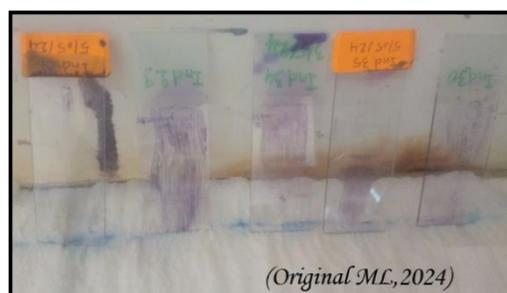
3- Après ont colorés avec une solution de Giemsa à 10 % (Atoyan et *al.*, 2018; Ciloglu et *al.*, 2020) a pH 7,0–7,2 (Valkiunas et *al.*, 2008) et à une température de 18-20 °C pendant 1 heure (Valkiunas et *al.*, 2008) en laboratoire (Santiago-Alarcon et *al.*, 2020; Valkiunas et *al.*, 2008) le même jour.(Londoño et *al.*, 2007)
