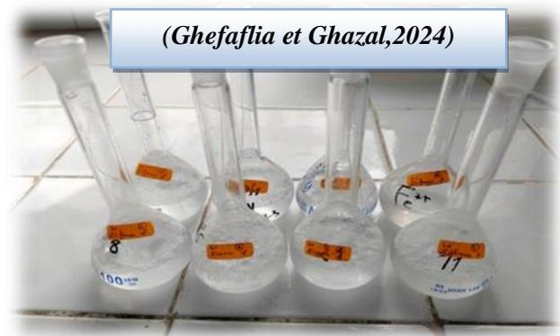
**Fig.20:** Dosage de Sulfate.
