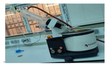
**Figure 6**: Appareil Rotavapor (Originale)
