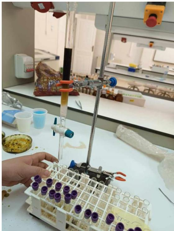
**Figure 19** : Séparation d'extrait par chromatographie sur colonne (Originale, 2024.)
