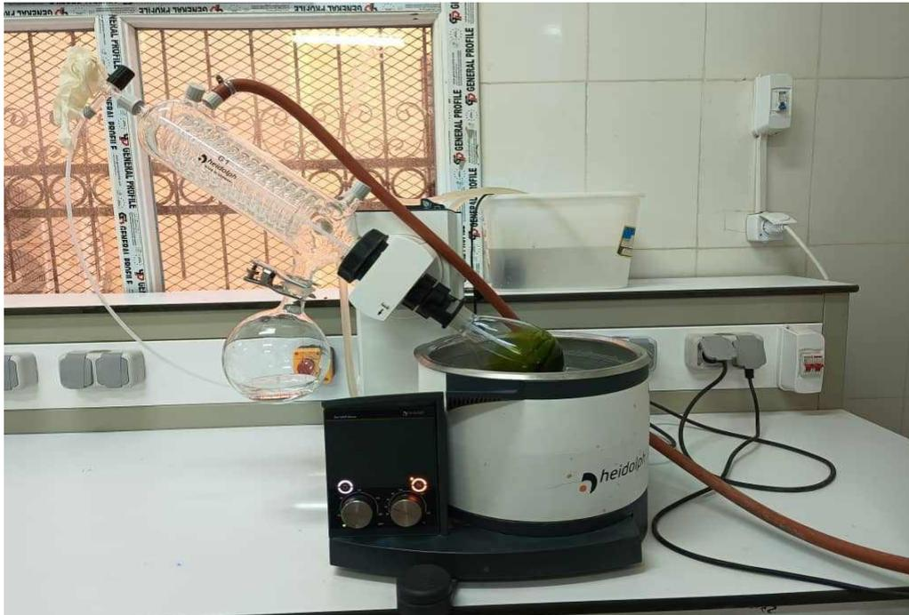
**Figure 17** : Evaporateur rotatif (ORIGINALE, 2024).
