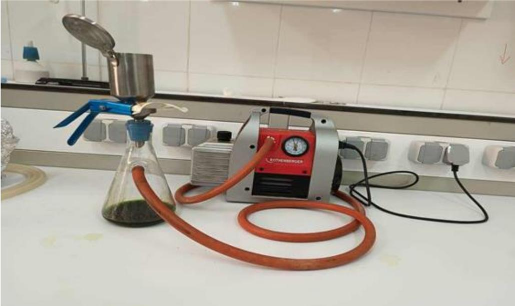
**Figure 16** : L'appareil de filtration sous vide (ORIGINALE, 2024).
