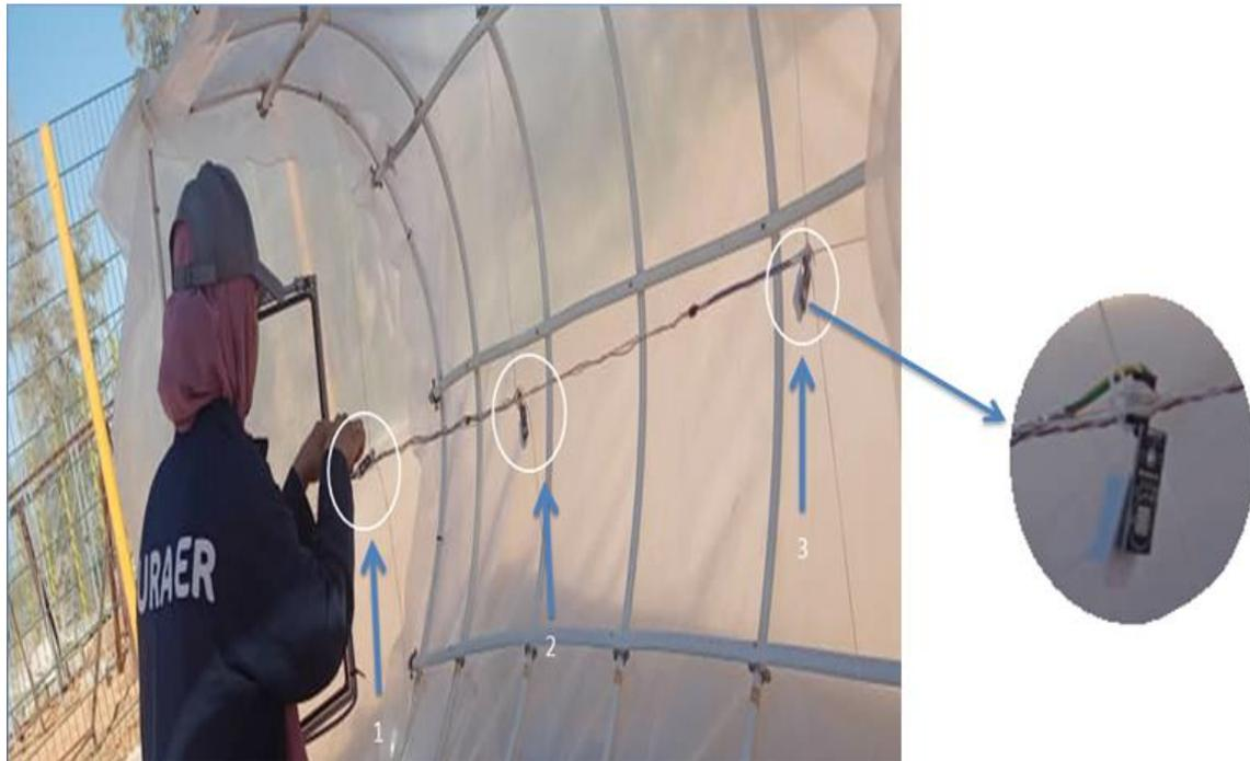
Figure 3 - 10: Emplacement du capteur dans les serres.
