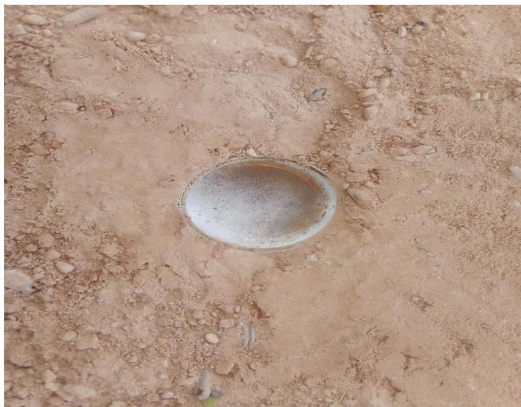
**Figure 12.** Méthode des pots-Barber sur terrain (original, 2024)
