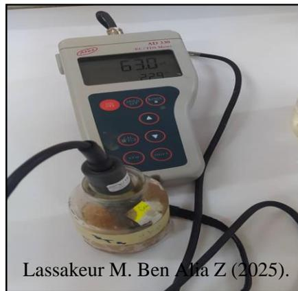
**Figure 16:** Analyse de conductivité électrique.
