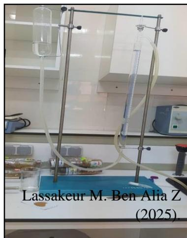
**Figure 18:** Dosage du calcaire total des échantillons.
