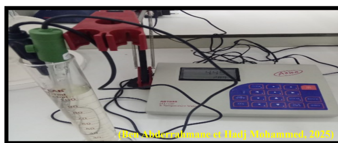
Figure 9 Mesure de pH à l'aide d'un pH mètre (photo originale)
