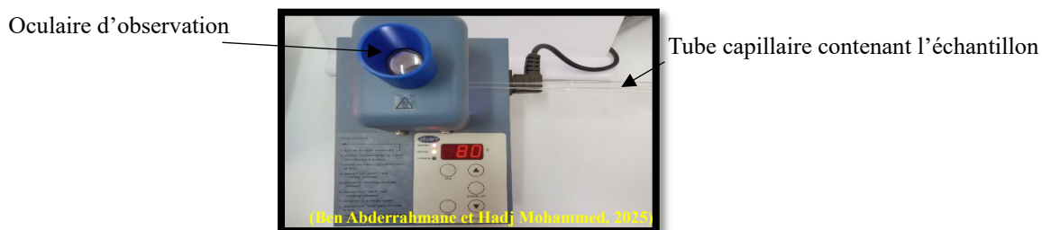
Figure 13 Mesure de point de fusion à l'aide d'un fusiomètre (photo originale)
