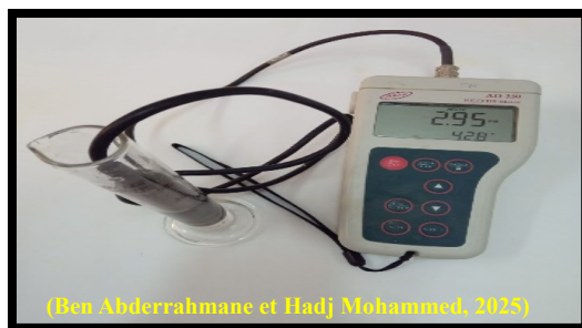
Figure 11 La mesure de conductivité à l'aide conductimètre (photo originale)
