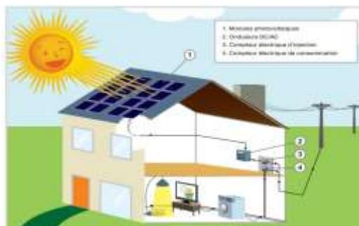
Figure 2.3: Explication des systèmes domestiques en réseau[12]
