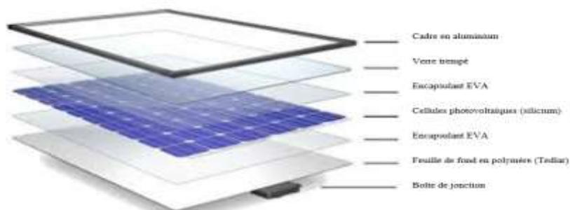
**Figure 1.8 :** Ingrédients des cellules solaire [21].
