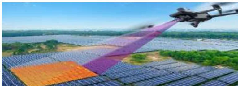
**Figure 1.16 :** Inspection du panneau photovoltaïque à l'aide d'un drone thermique [46].
