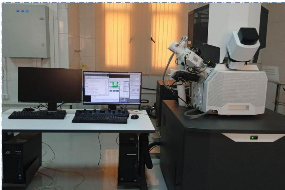
**Figure II.10:** Microscopie électronique à balayage couplé à l'EDX.
