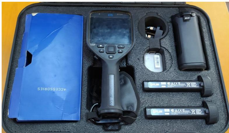
Figure III.8: Caméra Infrarouge (FLIR)
