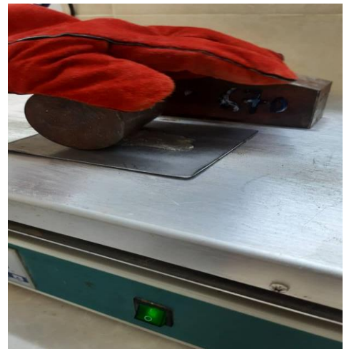
Figure II. 14 : adapter l'échantillon sur la plaque chauffante.
