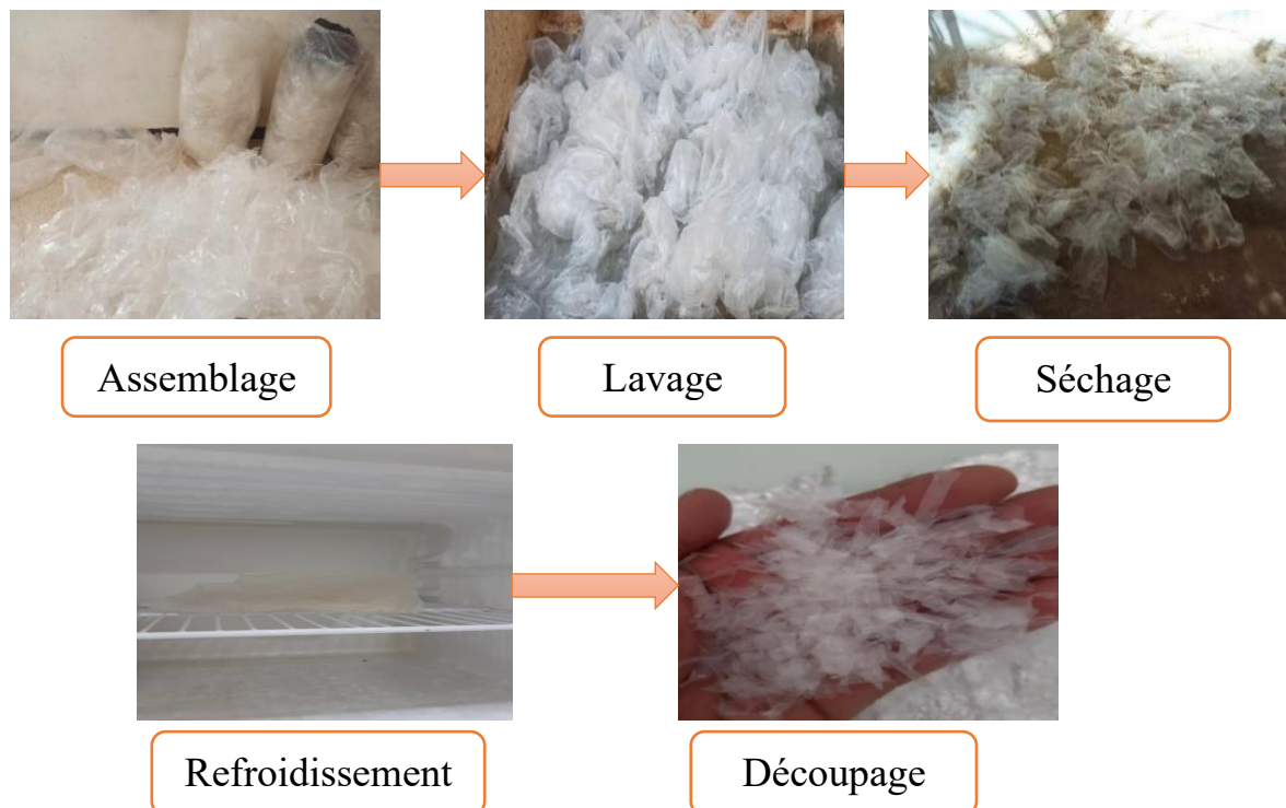
Figure II. 1 : les étapes de préparation de LDPE.
