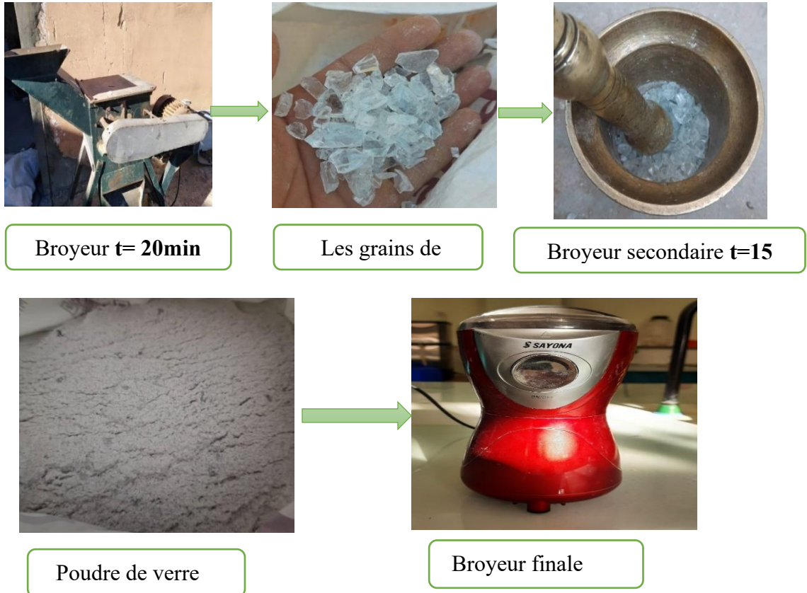
Figure II. 2 : les étapes de préparation de verre.
