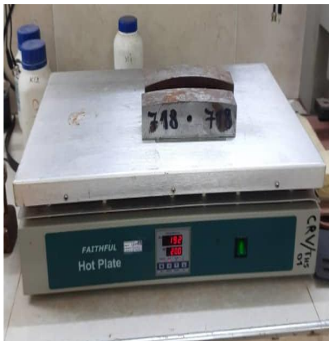
Figure II. 14 : adapter l'échantillon sur la plaque chauffante.
