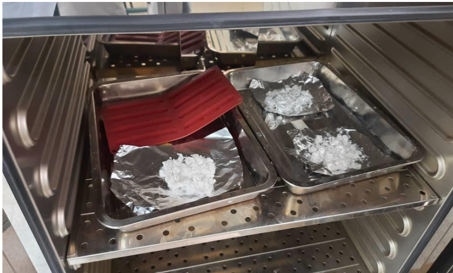
Figure II. 11 : dégazage des échantillons.
