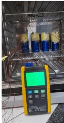
**Figure III.4.** Le procédé de solidification de  $\text{CaCl}_2 \cdot 6\text{H}_2\text{O}$ .
