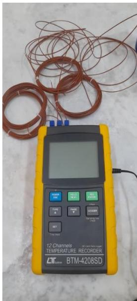
**12-channel température recorder, LUTRON BTM-4208SD**
