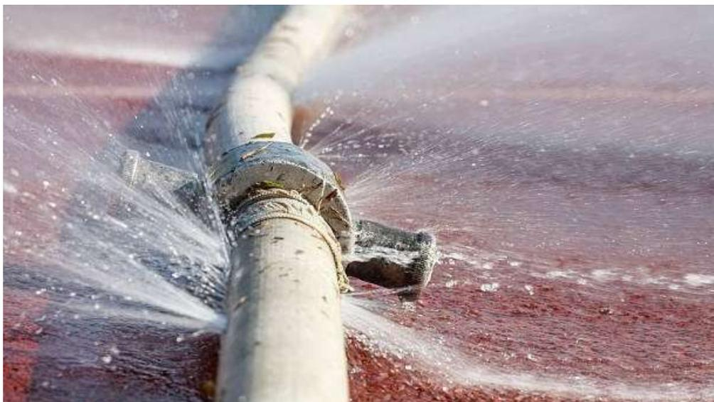
FIGURE 2.1 – Fuites d'eau dans un réseau d'irrigation [7]
