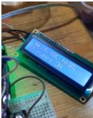
FIGURE 4.6 – Activation automatique de la pompe lorsque le sol est sec
