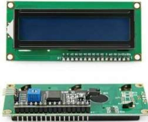
FIGURE 3.4 – afficheur LCD I2C
