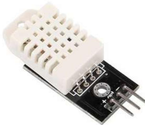
FIGURE 3.3 – Capteur DHT22
