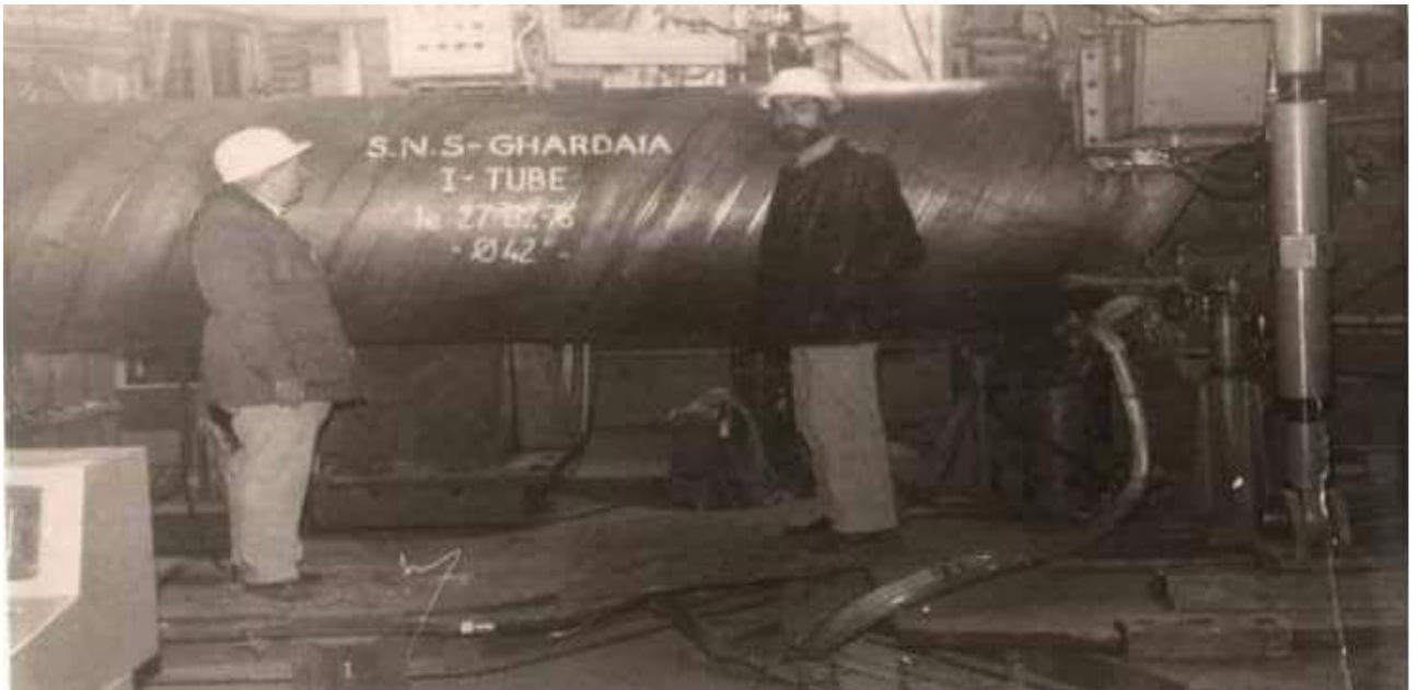
Figure.III.1: Le premier tube produit par la machine à souder spirale [6]
