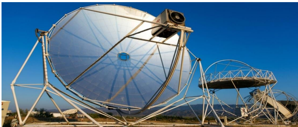
Figure I.8. Prototypé de système Dish-Stirling en fonctionnement [19].
