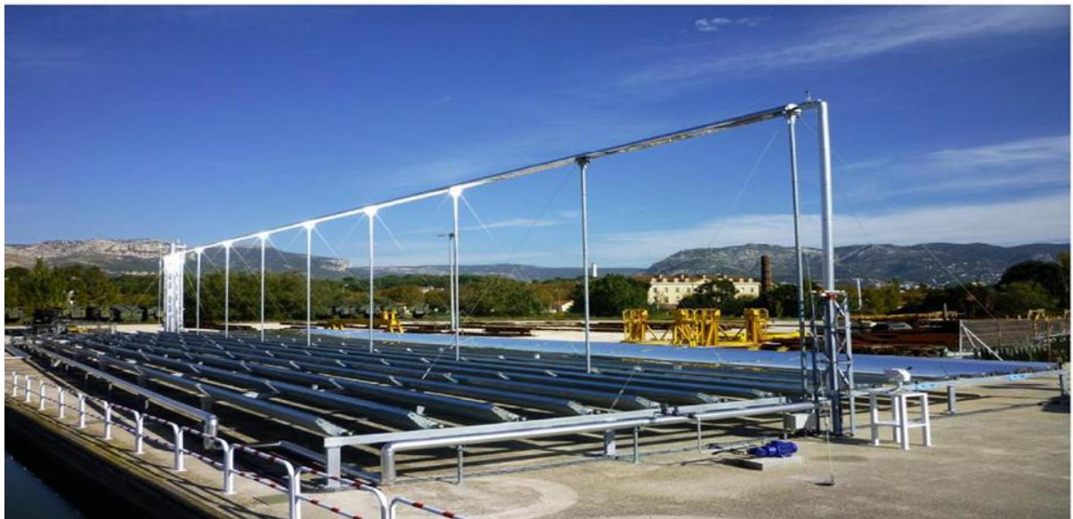
Figure I.10. Le réflecteur linéaire de Fresnel (RLF) [22].
