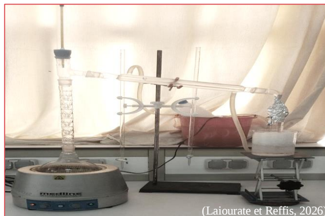
Figure 07 : Montage de distillation fractionnée de l'alcool de l'échantillon (vinaigre de dattes et pomme) (Photos originale, 2026).
