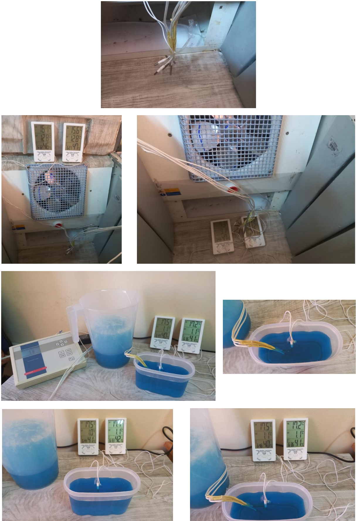
Figure 2.6 : Processus d'étalonnage des thermocouples en plusieurs étapes
