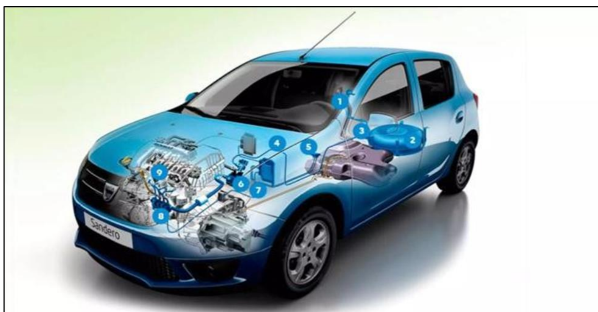
Figure 2-1 : Architecture générale d'un système GPL automobile.
