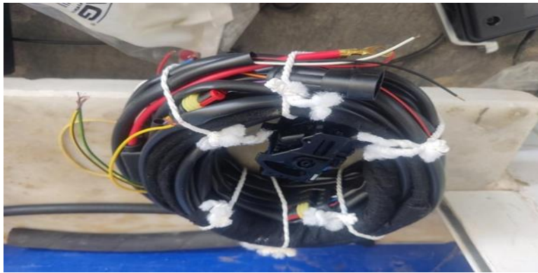
Figure 3-8 : Câblage électrique du système GPL.
