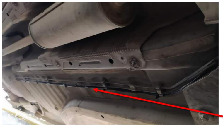
Figure 3-11: Conduites de gaz du réservoir.
